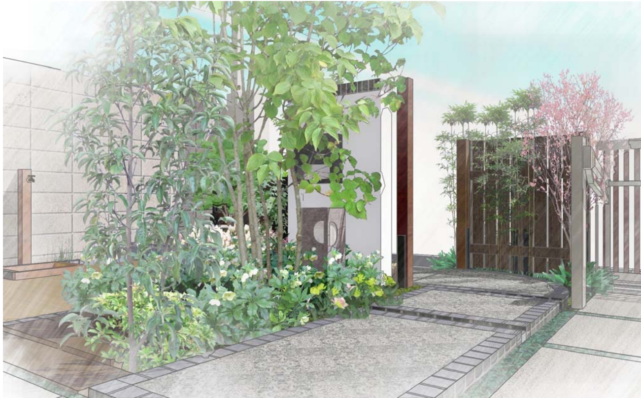
① 間仕切り板塀 板塀 105×30×1250 天然保護塗料ウッドロングエコ塗材 ピッチ 120で メチあき 15mm 柱 90×90×1250 棧分切り込み 板塀 105×30×1000 ピッチ 120で メチあき 15mm 棧 2段 90×40×L H型アンカー 1250 地盤 側溝高 35 板塀は柱の内側に入りま 棧は柱切り込 にて 2段 H型アンカー
