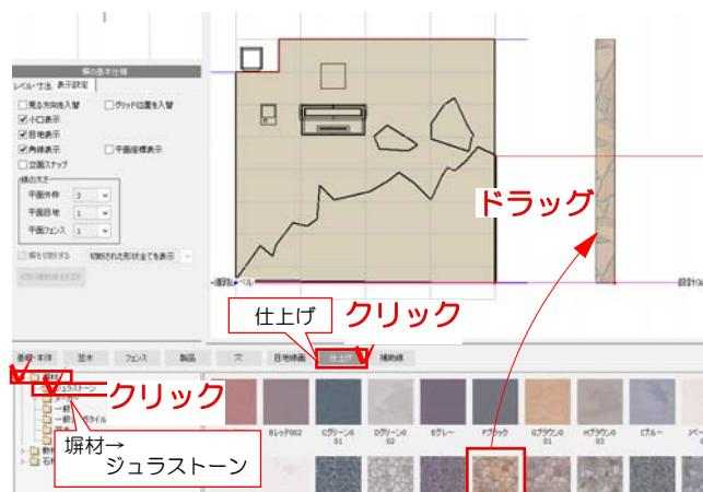
2-2 正面と位置を合わせるため補助線を配置します。
